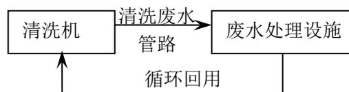
图 4 清洗废水回用流程图
