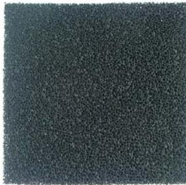
图5 玻璃纤维过滤棉示意图
