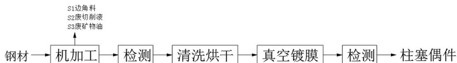
图 5-1 本项目生产工艺流程及产污环节图
