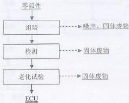
图 1-3 现有项目生产工艺流程及产污环节图
