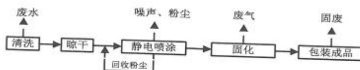
图 4.5-1 项目原环评生产工艺流程及产污节点图
